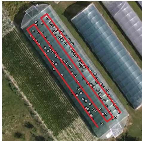
36. ábra – GPS/GNSS adatok grafikus megjelenítése (fehér körök) és a valós nyomvonal (piros vonal)
