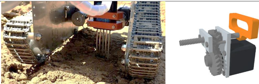
38. ábra – A talajérzékelő elhelyezkedése (a) és a mozgó mechanizmus (b)
