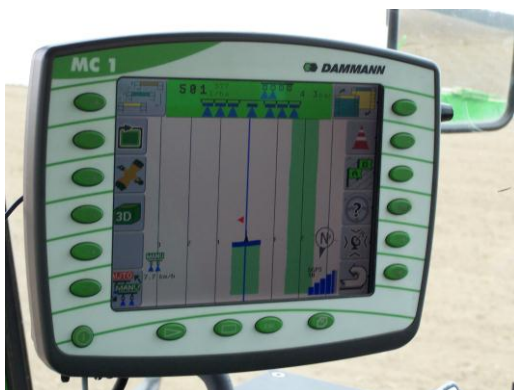
16. Ábra: A kijuttatás rögzítése a permetező fedélzeti számítógépén (saját felvétel 2011.)
