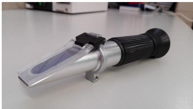
23. ábra: Az elletőszemélyzet számára hasznos, könnyen alkalmazható kiegészítő műszer a Brix refraktométer (saját fotó)
