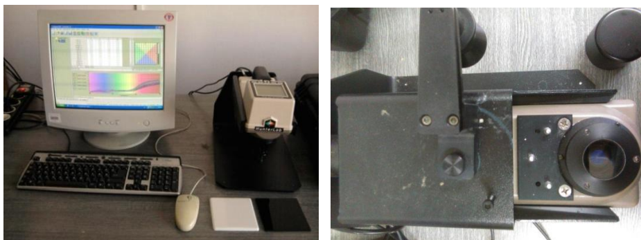
18. ábra: A vizsgálatok során használt HunterLab MiniScan XE Plus típusú reflexiós spektrokoloriméter
