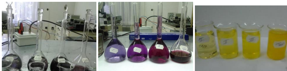
15. ábra: Antocianin: 1) szőlő kivonat (balra), 2) fekete répalé (középen), és béta-karotin (jobbra) tartalmú kalibrálóoldatok (Minták A1-A4, B7-B10, C1-C4)
