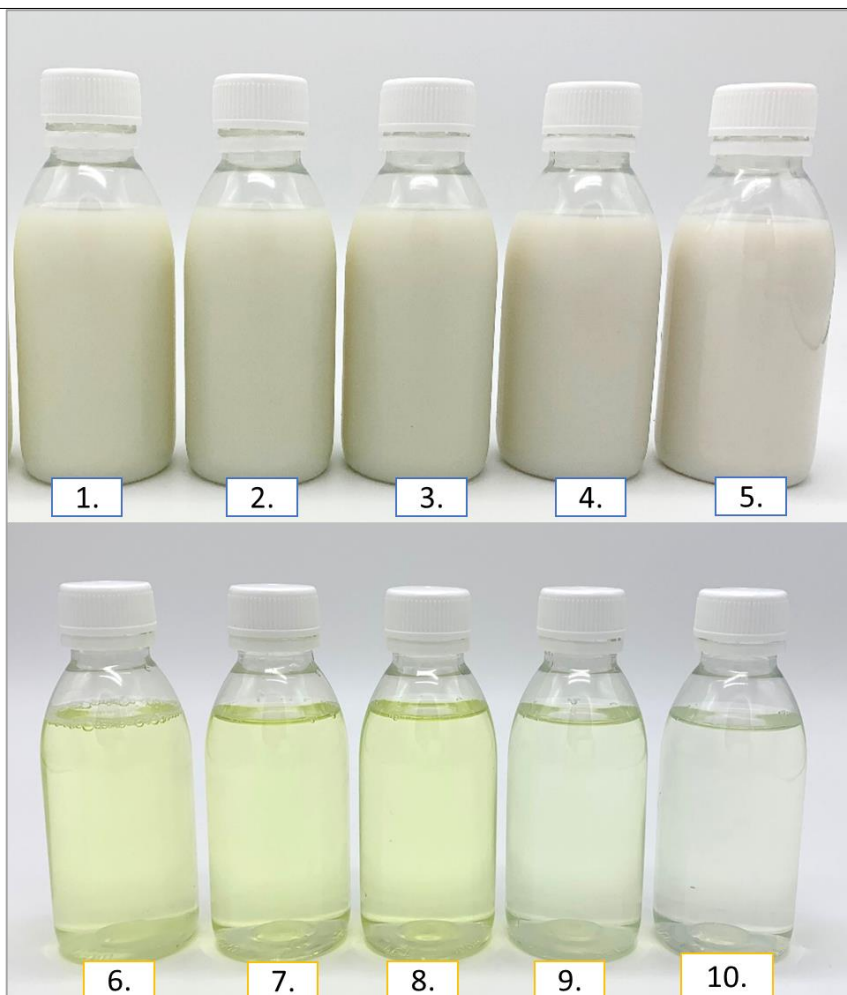
10. ábra: MF retentátum (1, 2, 3) MF/DF retentátum (4, 5) és a permeátum fázisminták (6-10) 0,5 \mu\text{m} pórusméretű membránnal 15 °C-os szűrési hőmérsékleten mikroszűrve.
