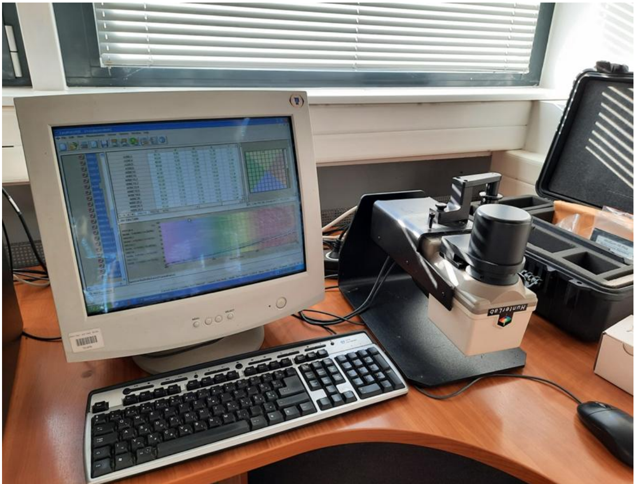
10.ábra CIELab Color Space színekép spektrométer illetve a hozzá tartozó szoftver program
