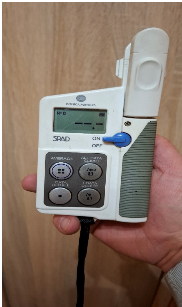
12. ábra Minolta 502 SPAD mérőkészülék (forrás: saját felvétel)
