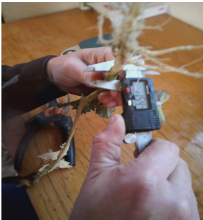
16. ábra Gyökérnyak vastagság mérése tolómérővel (forrás: saját felvétel)
