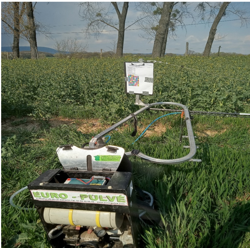
11. ábra Euro- Pulvé háti permetező (forrás: saját felvétel)
