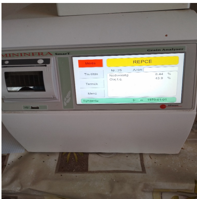
14. ábra Mininfra SmartT gabona analízáló (forrás: saját felvétel)
