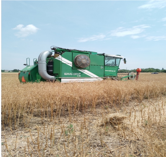
13. ábra Haldrup C-85 parcellabetakarító kombájn (forrás: saját felvétel)
