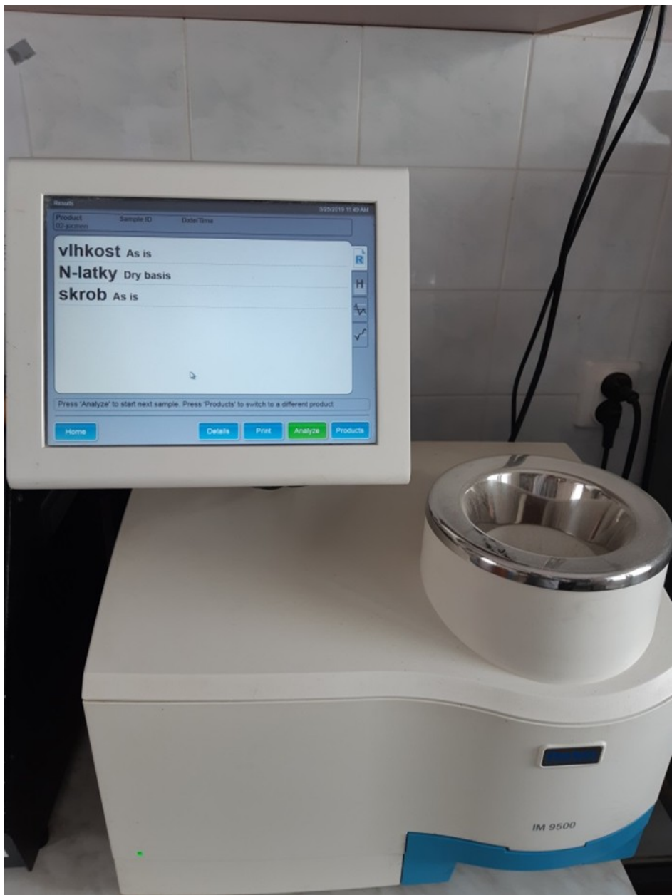
12. ábra: Perten Inframatic 9500 típusú, közeli infravörös spektrométer (saját felvétel)
