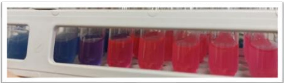
52. ábra: E. coli gátlási koncentrációinak meghatározása rezazurin oldat jelenlétében (forrás: saját kép)
