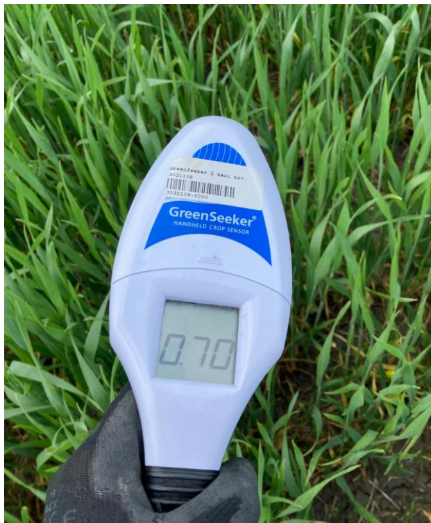
21. ábra: GreenSeeker HCS-250 típusú NDVI mérő szenzor adatgyűjtés közben.
